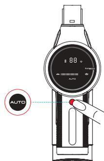
Al poner en marcha el aparato, el modo AUTOMÁTICO es el modo por defecto. Tarda 3 segundos para comprobar si hay obstrucciones y detectar la cantidad de polvo. Si no detecta polvo, se reduce la potencia de funcionamiento.
