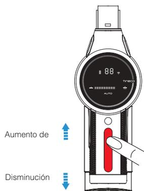
En el modo AUTO, deslice el control de potencia y el aparato entra en modo manual con el indicador AUTO apagado.
