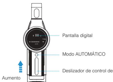
El aparato se activa en modo AUTOMÁTICO por defecto. Deslice el control de encendido para ir al modo manual. Presione el botón AUTO por 2 segundos para cambiar de nuev o.
